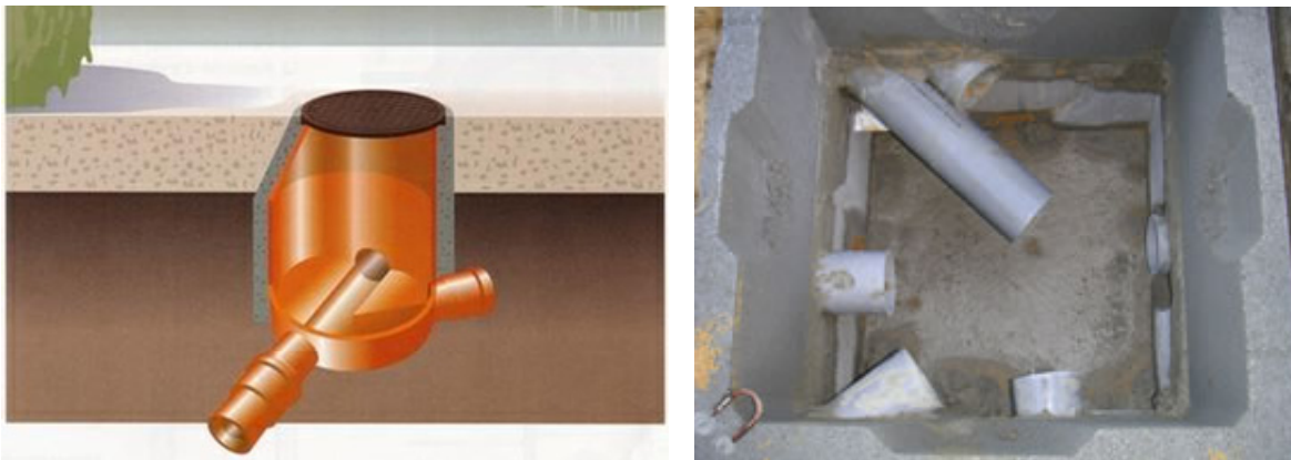
Figure 2 - Schéma de principe et photo d'une chambre de visite (appelée aussi regard)
