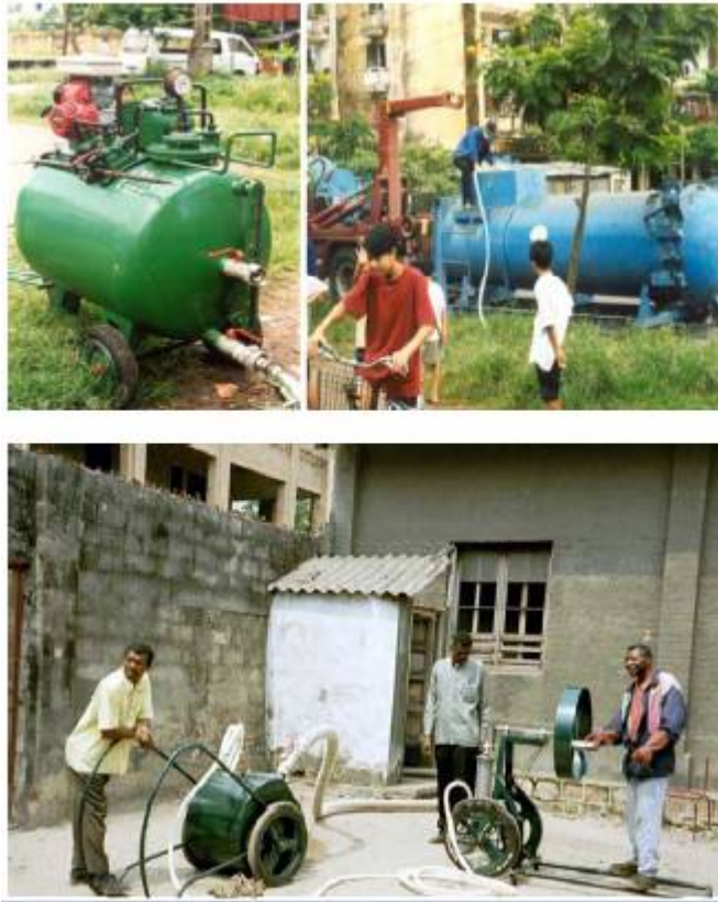
Figure 2: Mini Vacutug reliée à un camion citerne (en haut) et pompe de type MAPET (en bas) (Source : Fecal Sludge Management – EAWAG – 2002 )
