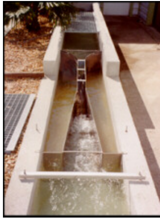
Figure 6 - Déversoir rectangulaire en mince paroi avec contraction latérale (source: halle-hydrau.g-eau.net )
